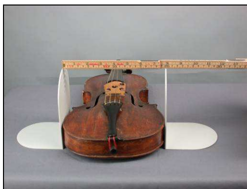
To vinkelrette elementer gjør det lettere å måle instrumentet
